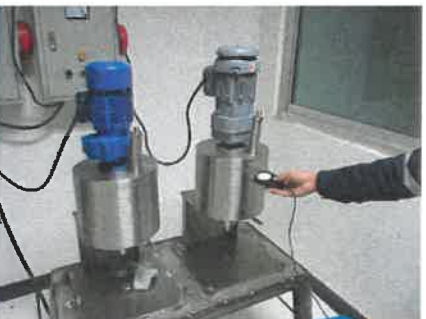
ห้องคอนโทรลหม้อเคียว: เครื่องบดเชื้อหม้อเคียว
